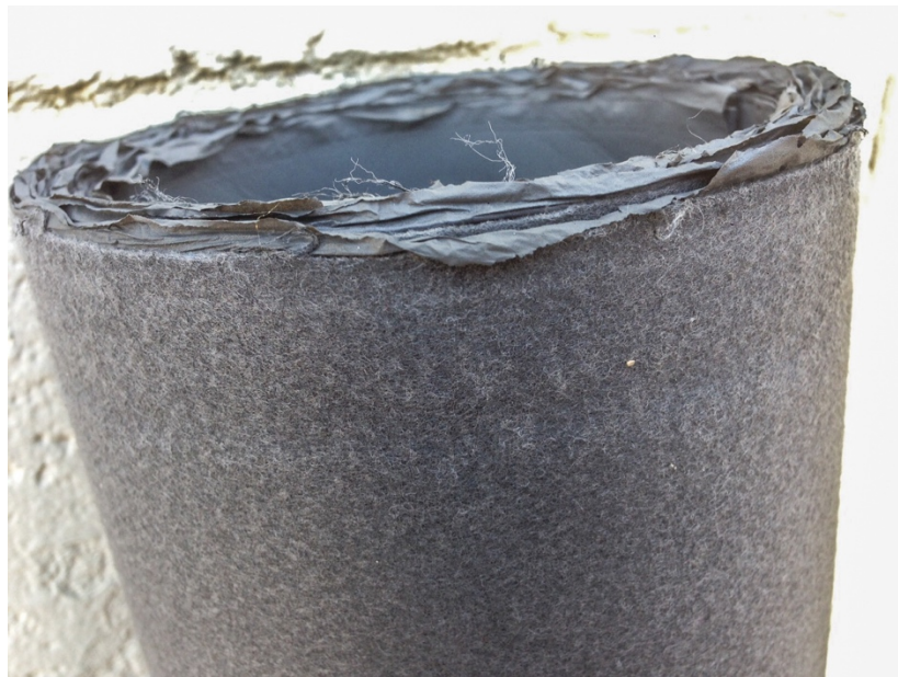
Fig. 1.24. Tela ahulada utilizada para cubrir la pericámara.
