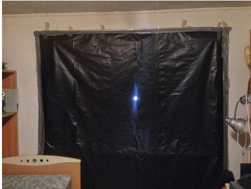
Fig. 1.15. Vista del sellado del cuarto y el estenopo que actúa como la entrada de luz.
